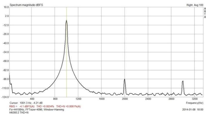
**THD** . infinitamente piccola per un' amplificatore di queste potenze è indice di un progetto ben amalgamato in tutte le sue componenti
