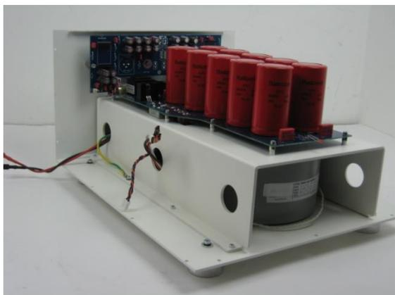
Questo stadio è completamente a componenti discreti , viene visto simile ad un'OpAmp e permette la superiorità sonica di amplificare il segnale in corrente. Il circuito HDCA dispone di una banda passante di 1Mhz , una distorsione prossima allo 0,00001% , linearità entro 0,1db tra 1hz e 250.000hz garantendo sempre un perfetto interfacciamento con qualsiasi sorgente.
