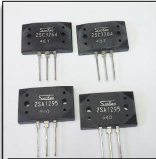
2 coppie per canale dei pregiati C3264/A1295 assicurano un'elevata corrente di uscita in qualsiasi condizione di carico ed elevata affidabilità
