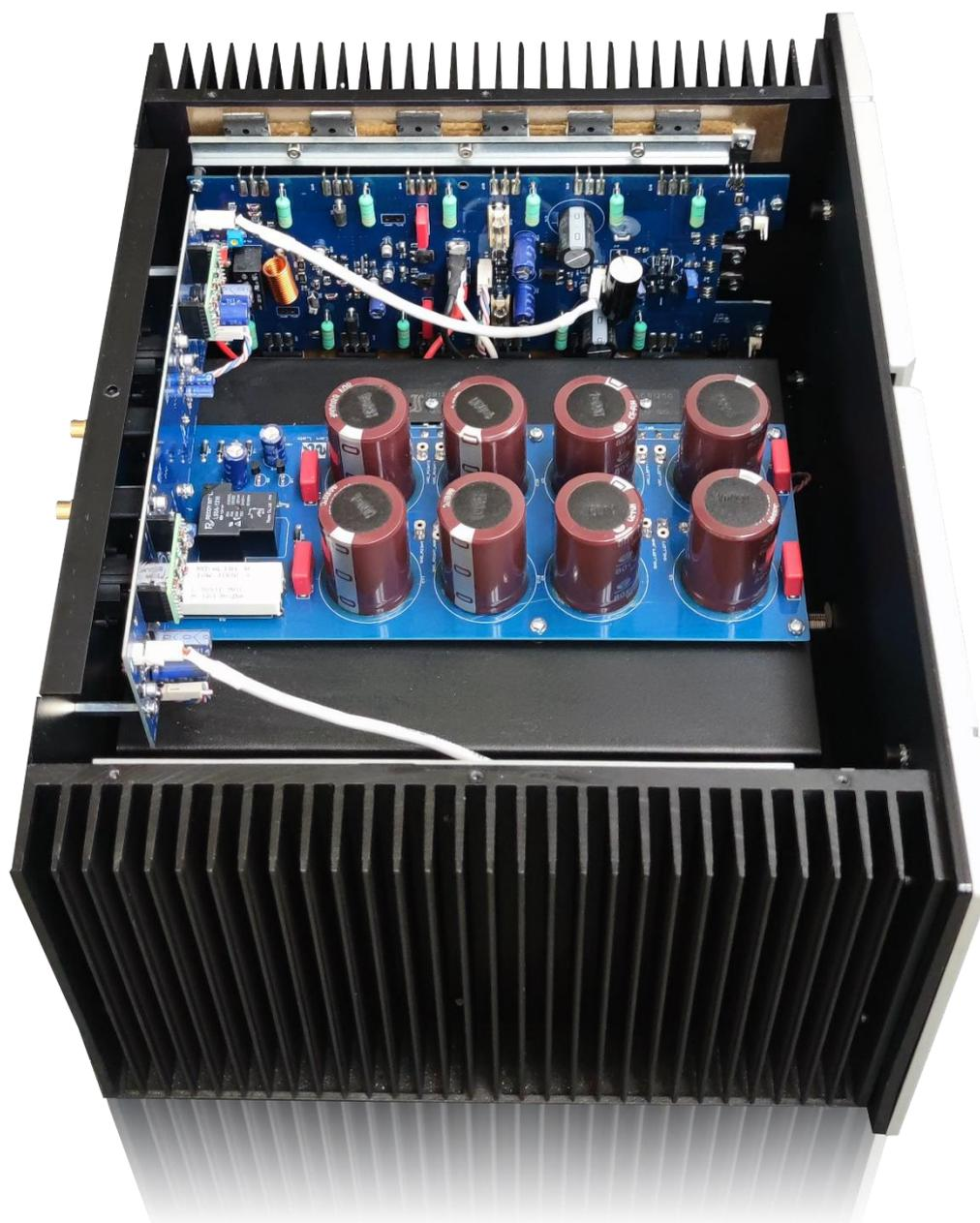
El transformador de potencia, además de estar blindado, va montado bajo una cubierta de hierro lo que aumenta aún más su rechazo a perturbaciones. En cambio, todo el banco de filtros y los diodos rectificadores están montados en una PCB con cobre de 70 micrones sin cableado de aire.
